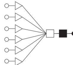
Примечание: светлые кружки – входные переменные, треугольники – нейроны входного слоя, светлый квадрат – нейрон промежуточного (скрытого) слоя, темный квадрат – выходной нейрон, темный кружок – значение выходной переменной после постпроцессирования, линии – связи между нейронами.
