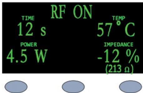
Рис. 3 Параметры абляции.
