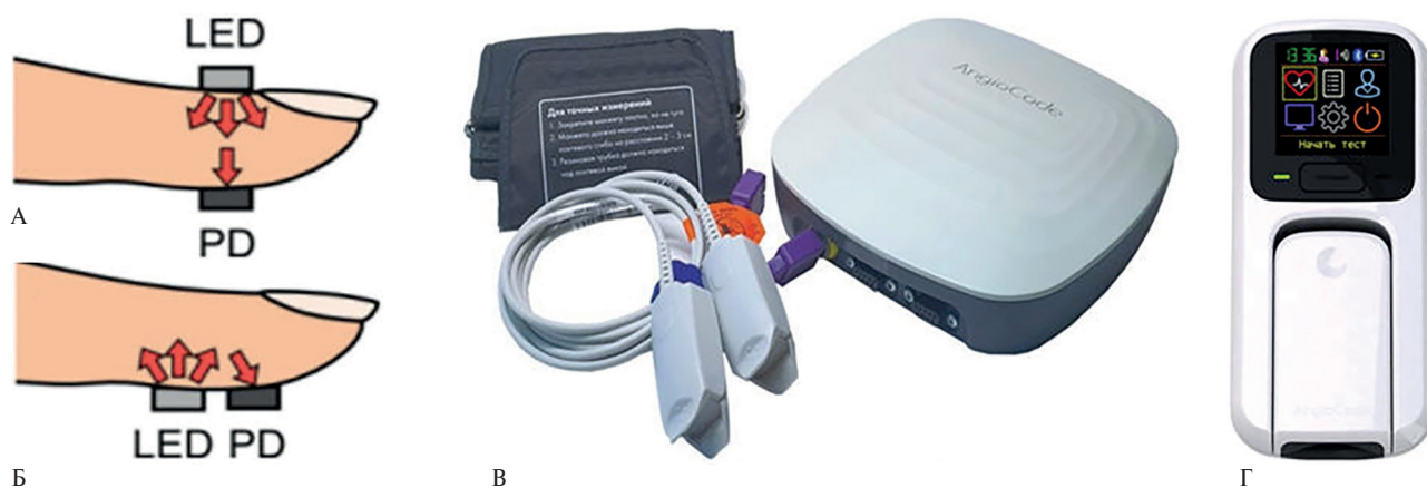
Рис. 4 ФПГ: А — ФПГ в режиме пропускания; Б — ФПГ в режиме отражения; В — двухканальный фотоплетизмограф на пропускание "AngioCode-322"; Г — одноканальный вариант портативного фотоплетизмографа на пропускание "AngioCode-301" с дистанционной передачей данных.
